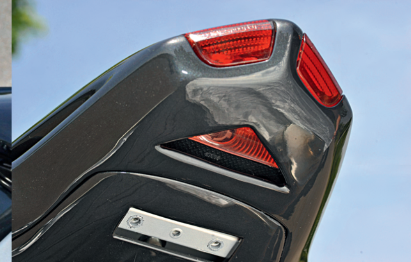
Die Beleuchtung ist schlau verlegt. Das Rücklicht beleuchtet auch das Kennzeichen. Das Sitzpolster kommt von Petra Grünberg ( www.spitzenwerk.de )
